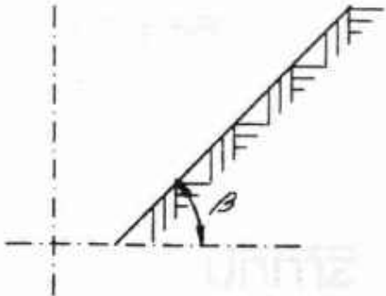
Obrázek 2 - Úhel \beta nezapažené stěny rýhy
