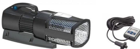
Obr.: Čerpadlo 44000 l/hod. s regulátorem výkonu (průtoku) – 700 W, 230 V, 50 Hz, kabel 10 m, hadicové napojení 38/50 mm, ponorné (mokrý instalace), ochrana před chodem nasucho, řídicí jednotka pro regulaci průtoku napojená na čerpadlo
