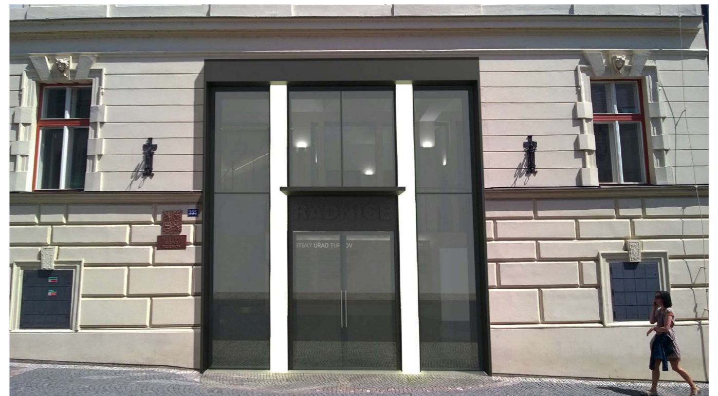
Návrh: nové ostění z plechového profilu; zakrytí překladu plechovým obkladem; velkoformátová skla v hliníkových rámech; opláštění sloupů plechem a podsvícenými panely; označení budovy na kovové desce nad vstupem; nad vstupem stříška z plechu; všechny kovové prvky mají povrchovou úpravu v antracitové barvě.
